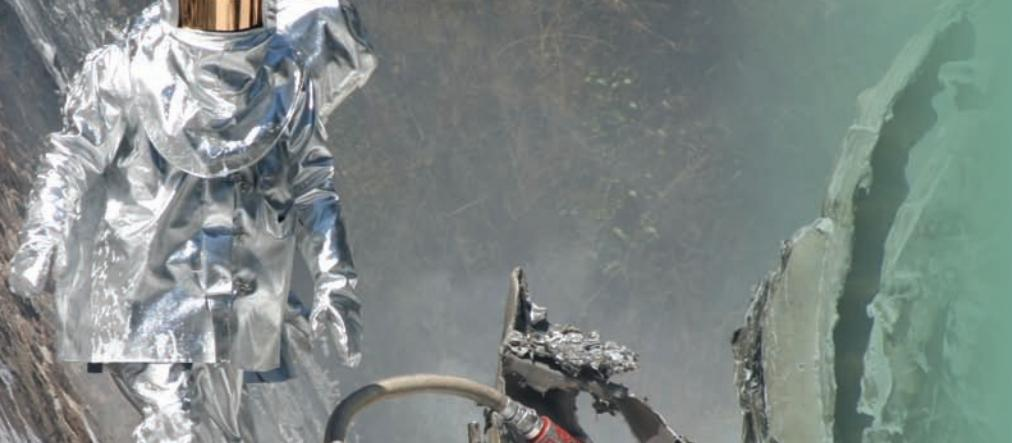
室外测试工厂能让我们的织物进入实际的生活环境，例如：酸雨环境，这在实验室内是无法复制的。在佛罗里达州和亚利桑那州的测试工厂提供有太阳暴晒的极端环境，而佛罗里达州还提供有高湿度环境。我们还与科罗拉多州的室外实验中心合作，采用反光镜来增加太阳暴晒效果。
